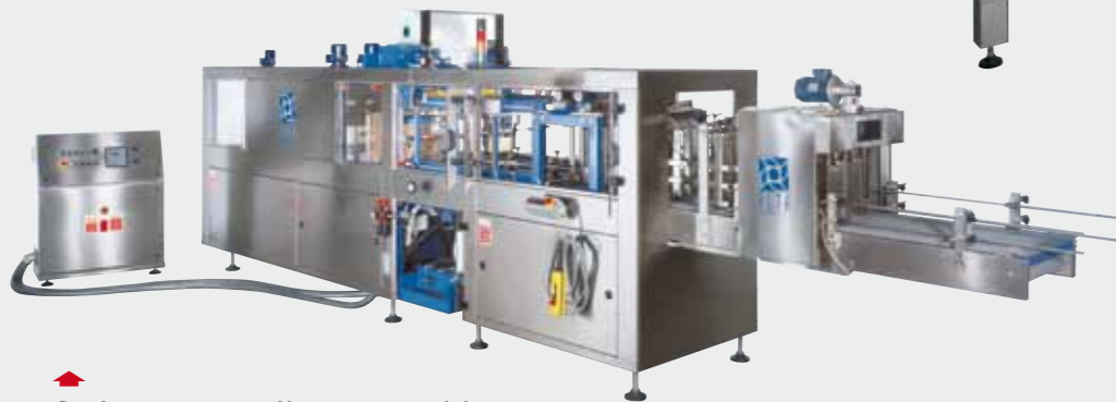
Incartonatrice-decassettrice automatica Automatic case packer-unpacker Encartonneuse-décartonneuse automatique Encajonadora-Desencajadora automática
