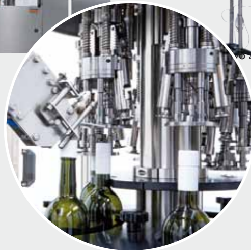
Tappatore rotativo Rotary Capper Boucheuse rotative Tapadora rotativa
